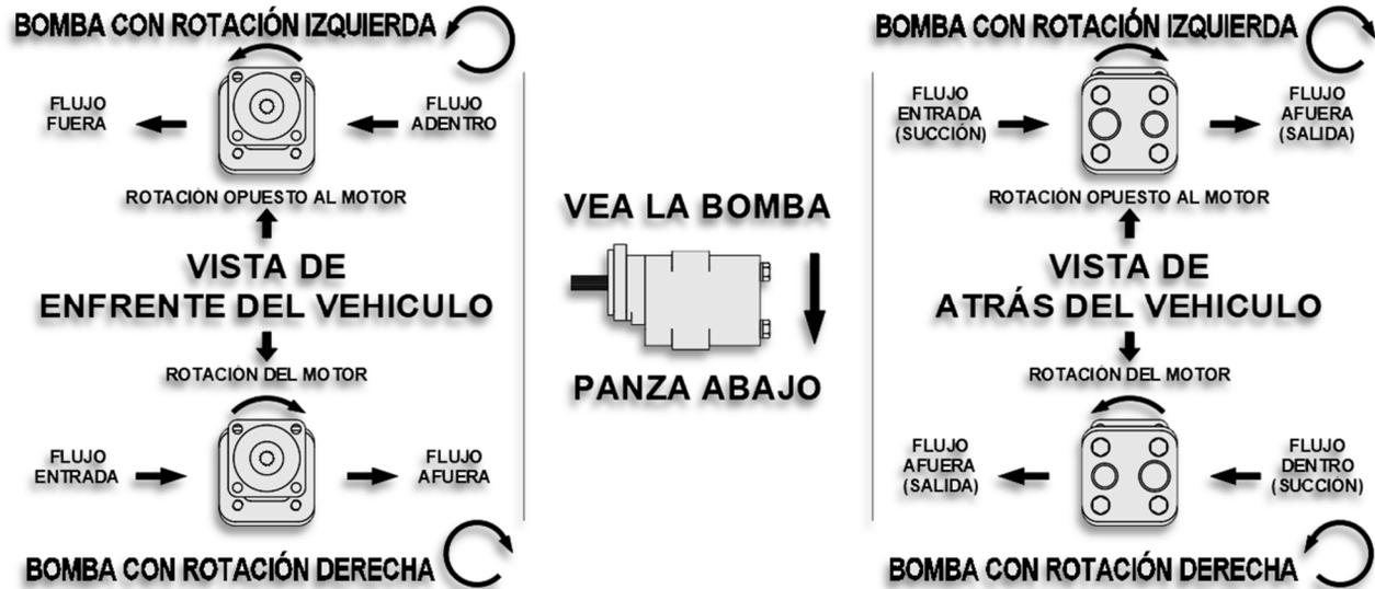
Determina la rotación de la bomba con la bomba panza abajo (vea ilustración). Viendo desde atrás de la bomba, si el orificio de succión (orificio más grande) está por el lado derecho, entonces la bomba es CW o sea de rotación derecha.
