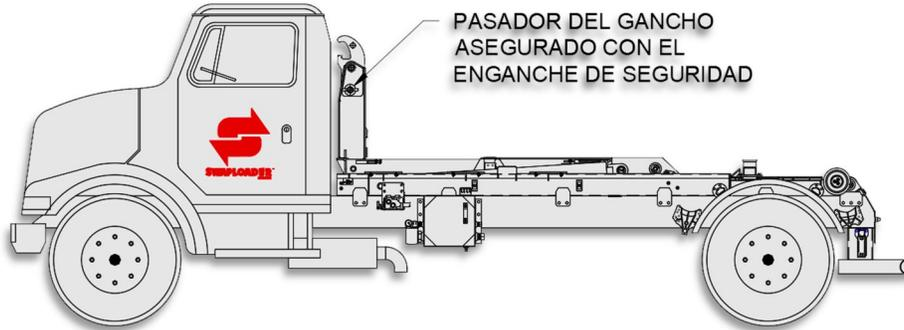
**PASO 1.** CON EL BRAZO TELESCOPIO EN POSICIÓN DE TRANSPORTE (MOSTRADO ABAJO); QUITA EL ENGANCHE DE SEGURIDAD DEL PASADOR DEL GANCHO. LUEGO QUITA EL PASADOR.
