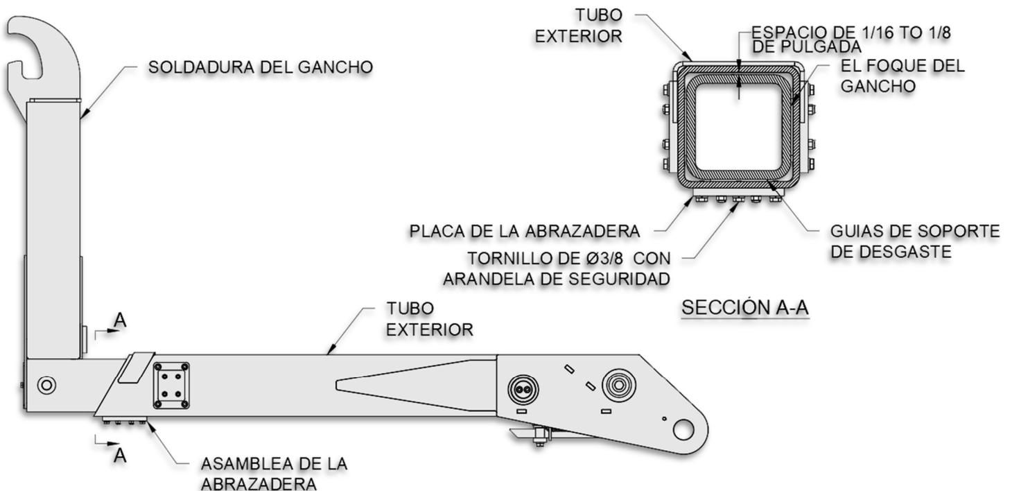
**ILUSTRACIÓN DE LA ASAMBLEA DE LA ABRAZADERA, SL-160, SL-212 Y SL-214**
