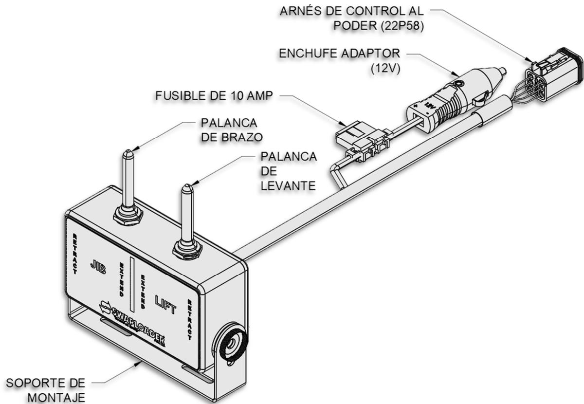
4. Cables la conexión o enchufe el adaptador de 12V para la caja de control.
