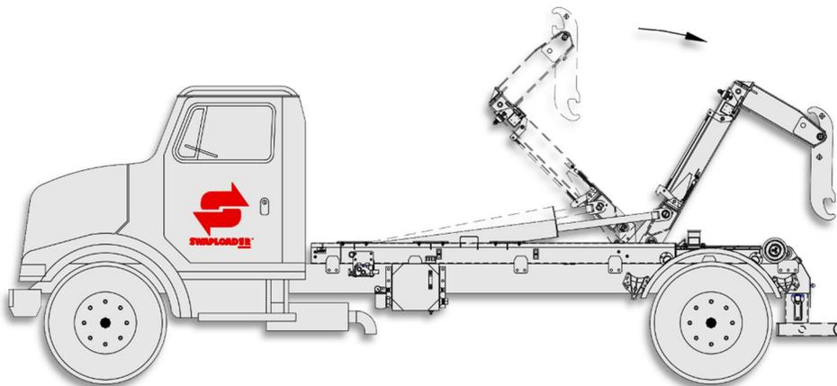
**PASO 3.** INCLINA EL BRAZO TELESCOPIO HACIA ATRÁS (PALANCA DE CONTROL IZQUIERDA HACIA ATRÁS).
