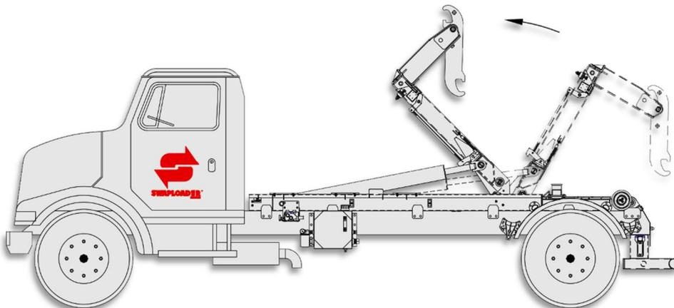
**PASO 2.** INCLINA EL BRAZO TELESCOPIO HACIA AL CABINA (PALANCA DE CONTROL IZQUIERDA HACIA ADELANTE).
