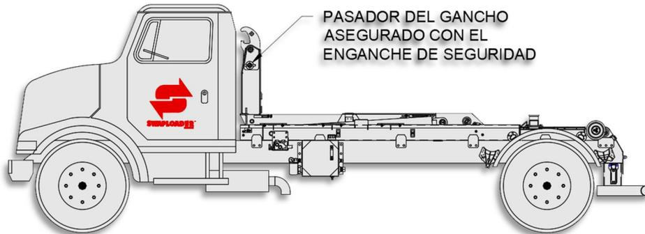
**PASO 4.** CON EL BRAZO TELESCOPIO COMPLETAMENTE EXTENDIDO EN POSICIÓN DE TRANSPORTE (MOSTRADO ABAJO); PONE EL PASADOR DEL GANCHO Y SE LO ASEGURA CON EL ENGANCHE DE SEGURIDAD.
