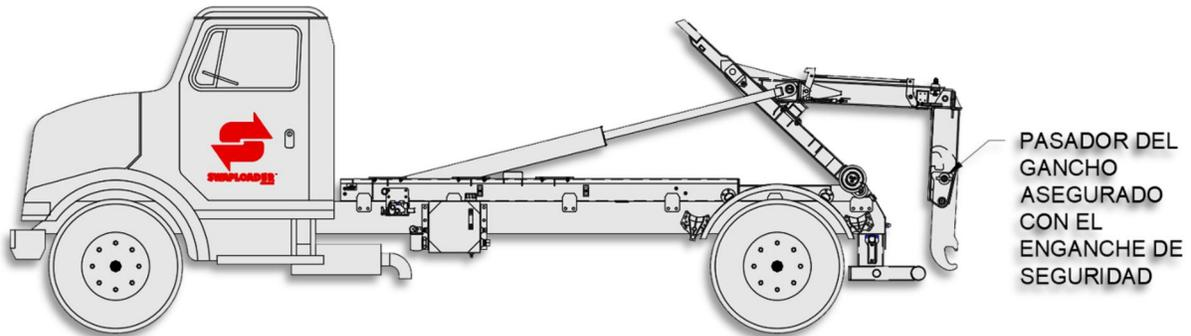
**PASO 1.** CON EL BRAZO TELESCOPIO COMPLETAMENTE EN LA POSICIÓN DE CARGAR/DESCARGAR (MOSTRADO ABAJO); QUITA EL ENGANCHE DE SEGURIDAD DEL PASADOR DEL GANCHO. LUEGO SACA EL PASADOR DEL GANCHO.
