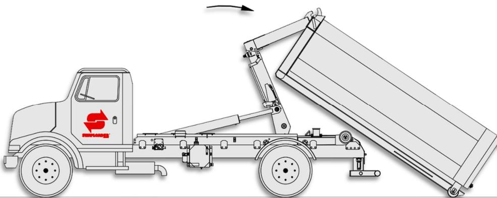
**PASO 2.** INCLINA EL BRAZO DEL GANCHO HACIA ATRÁS (PALANCA DE CONTROL IZQUIERDA HACIA ATRÁS). CUANDO EL CONTENEDOR TOCA AL SUELO, SUELTA LOS FRENOS PARA LIBRAR EL CAMIÓN PARA MOVIMIENTO (DEL CAMIÓN) ADELANTE CAUSADO POR COLOCAR EL CONTENEDOR EN EL SUELO.
