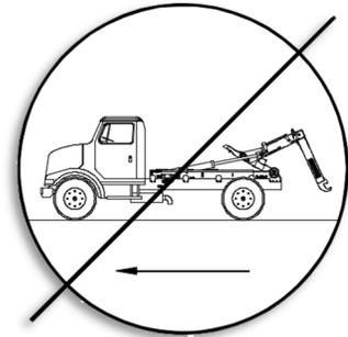
4. No exceda 1500 RPM del motor mientras que la toma de fuerza opera. Nunca transporta el equipo con la toma de fuerza en operación.
