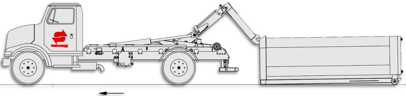
**PASO 3.** SIGUE INCLINANDO (BAJANDO) EL BRAZO DE GANCHO HASTA QUE EL CONTENEDOR SE ACUESTA SOBRE EL SUELO. AVANZA EL CAMIÓN SEPARANDO EL AGUILÓN (GANCHO) DEL CONTENEDOR. REGRESA EL BRAZO DEL GANCHO A SU POSICIÓN DE TRANSPORTE.
