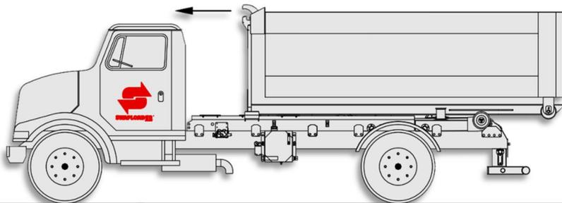
**PASO 5.** CUANDO EL CONTENEDOR SE ACUESTA SOBRE EL BASTIDOR DEL GANCHO, MUEVE EL CONTENEDOR ADELANTE COMPLETAMENTE PARA ASEGURAR QUE EL CONTENEDOR ESTÁ ENCERRADO EN LAS CERRADURAS DESLIZANTES (PALANCA DE CONTROL DERECHA ADELANTE). DESENGRANA LA TOMA DE FUERZA. **ENGANCHE LA CERRADURA-U (SI ESTÉ INSTALADA).**
