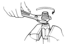
(atornillar hacia la izquierda) hasta el punto marcado en la manguera. Atornillar el inserto hasta que el inserto toca con el enchufe. Limpia la manguera con aire comprimido. Instala la asamblea en la entrada de la válvula de control y la salida de la bomba hidráulica.
